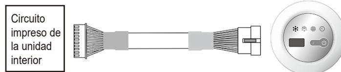
La conexión del cable de comunicación
