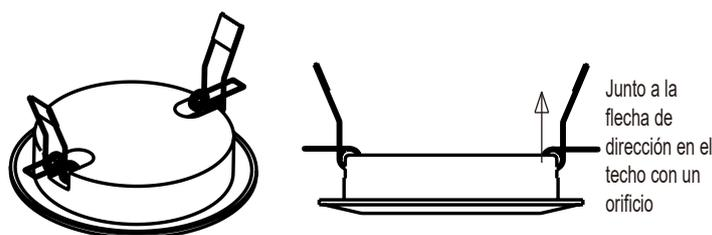
Instalación del receptor
