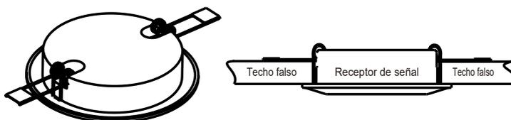
Después de la instalación completa
